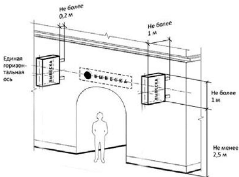
Витринные конструкции размещаются в витрине, с внешней и (или) внутренней стороны остекления витрины объектов; не должны выходить за плоскость фасада объекта; допускается размещение в виде отдельных букв и декоративных элементов.
