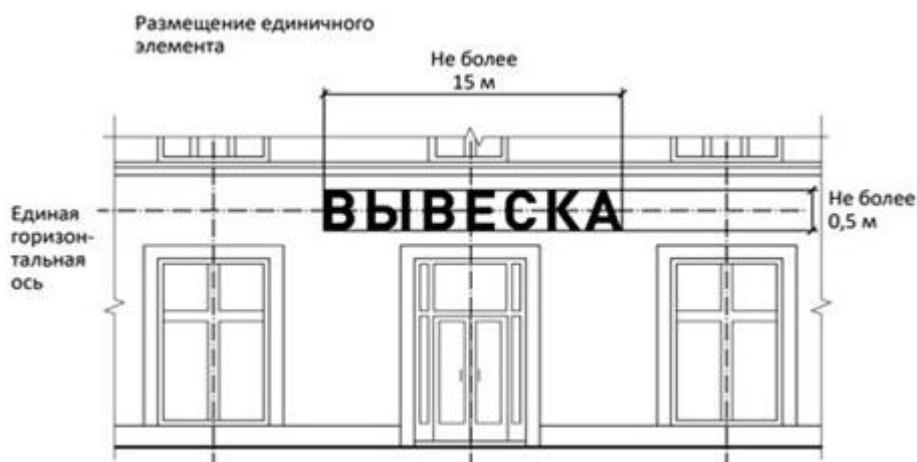
3) при наличии на фасаде объекта фриза настенная конструкция размещается исключительно на фризе на всю высоту фриза. Вывески на фризе могут быть изготовлены с использованием подложки или без неё. Подложка выполняется на всю длину занимаемого помещения, высота подложки равна высоте фриза, текстовая и художественная часть вывески равна 70% длине и 70% высоте фриза. Возможно размещение в виде светового короба на всю высоту фриза.
