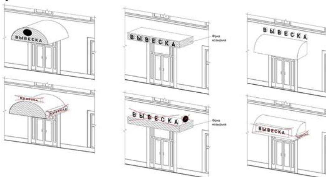
Консольные конструкции располагаются в одной горизонтальной плоскости фасада у арок, на границах и внешних углах зданий, строений, сооружений в соответствии со следующими требованиями:
