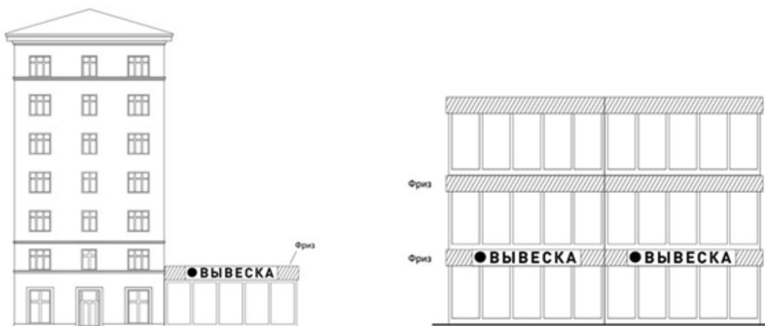
При наличии на фасаде объекта козырька настенная конструкция может быть размещена на фризе козырька строго в габаритах указанного фриза.
